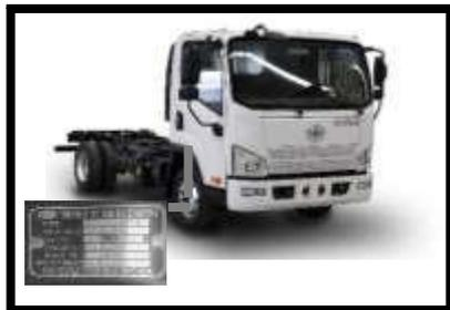
**Posición:** En camión, volquete y vehículo especial, se encuentra en la parte delantera de la viga longitudinal derecha del bastidor.
