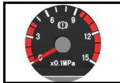
El indicador de presión de aire contiene dos agujas. La aguja superior indica la presión del circuito de frenado delantero y la inferior indica la presión del circuito de frenado trasero. Si la aguja se ubica en zona roja, significa que la presión está alta o baja.
