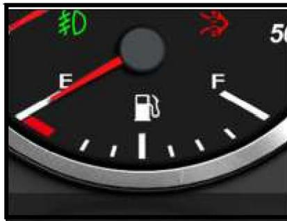
El primer bloque en la izquierda del indicador de combustible indica que el tanque está vacío. El
