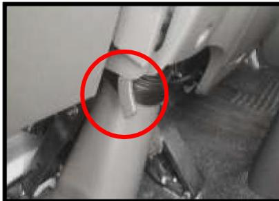
La palanca de posiciones del volante está en el lado izquierdo de la columna de dirección. Suelte la palanca de posiciones para regular la posición del volante. Podrá deslizar hacia arriba, abajo u oscilar hacia adelante, atrás. Después de la regulación, se necesita bloquear la palanca de bloqueo (presione la palanca de bloqueo hacia abajo).
