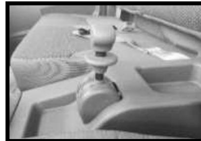
La palanca de operación del freno de estacionamiento se ubica en el lado derecho del asiento del conductor, (parte trasera de la palanca de cambios). Durante el frenado de estacionamiento, tire la palanca de operación del freno hacia atrás al tope.
