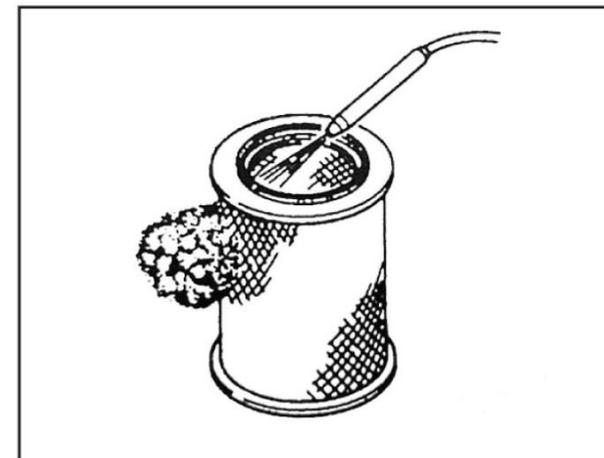
► En las regiones generales, se debe realizar un mantenimiento para el elemento del filtro principal después de cada 10.000km de recorrido, y el elemento del filtro principal debe ser reemplazado después de 4 veces de mantenimiento o 1 año de uso.
