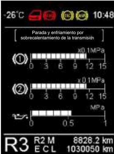
consumo de combustible, la presión del aceite de motor, la tensión de la batería y la información de alarma. Gire el botón derecho hacia la izquierda/derecha para cambiar la interfaz principal.
